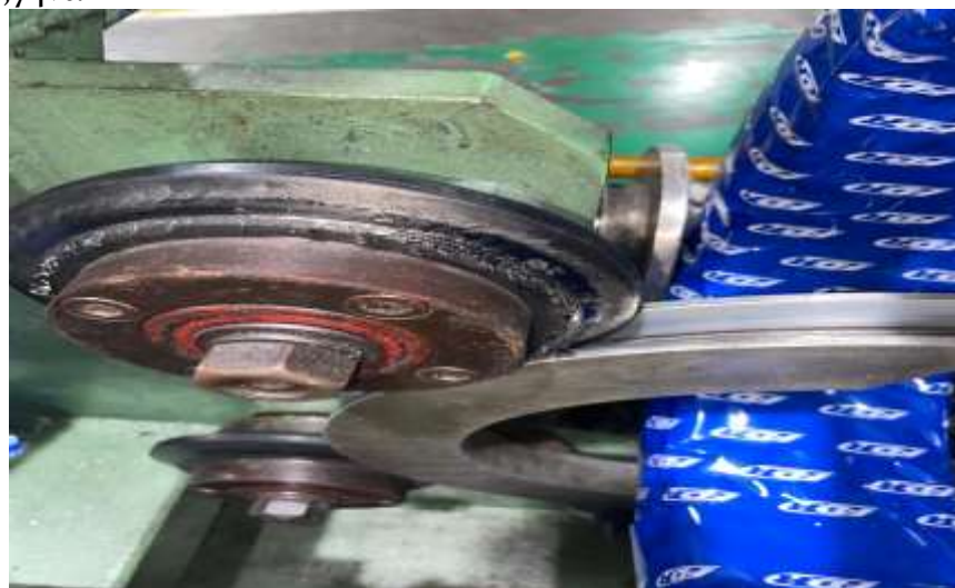
Gambar 1. Rubber Wheels yang belum diganti
